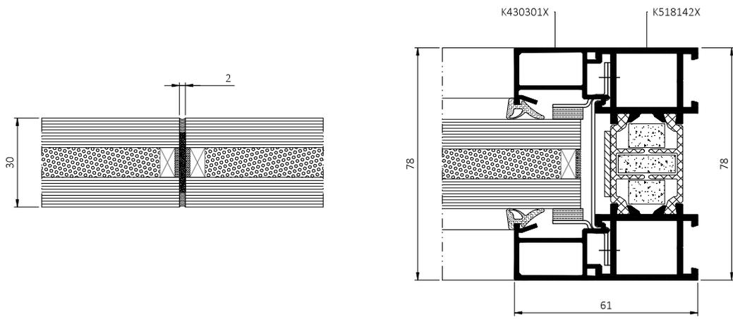
Cloison MB-78EI avec vitrage bord à bord, vue verticale
